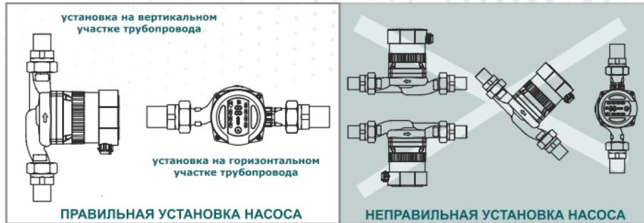
**Рис.2 Установка циркуляционного насоса.**
