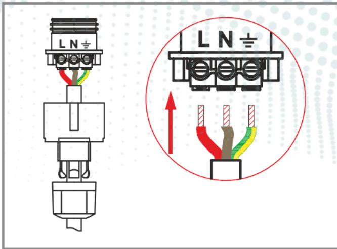
**Рис.3 Схема подключения насоса.**
