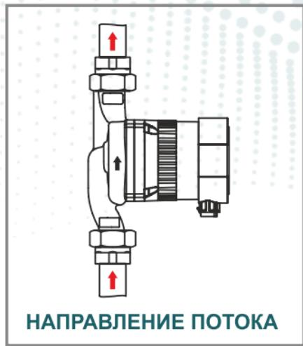
**Рис.3 Направление потока циркуляционного насоса.**
