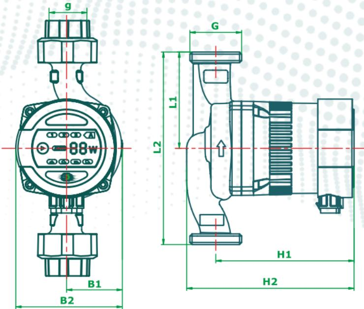
Рис.1 Обозначение монтажных размеров насоса.
